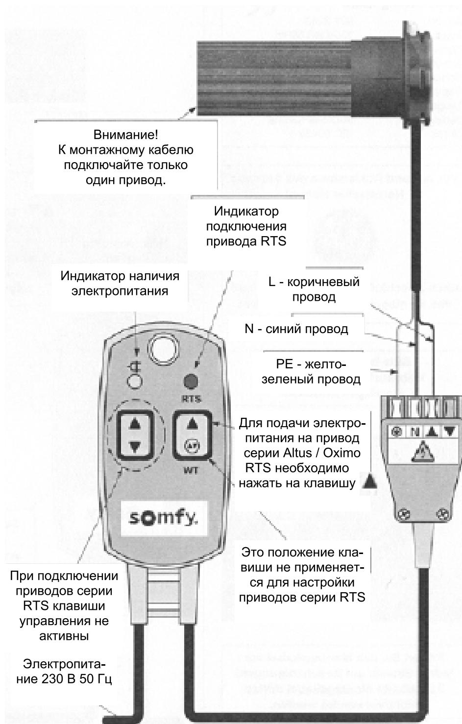
Дальнейшая настройка и программирование приводов серии Altus / Oximo RTS производится согласно инструкции на данную серию приводов!
